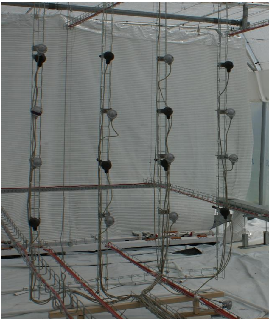
Rysunek 20. Rozmieszczenie elementów pomiarowych w obiekcie doświadczalnym
