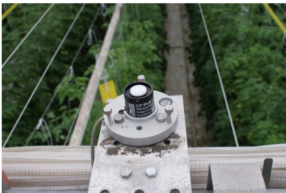
Rysunek 17. Czujnik promieniowania LP PAR
