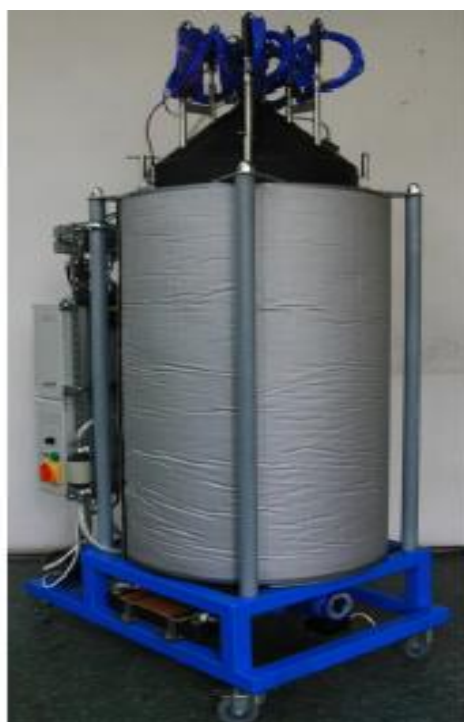
Rysunek 6. Bioreaktor laboratoryjny typu BKB 100 (po lewej) oraz schemat budowy (po prawej)
