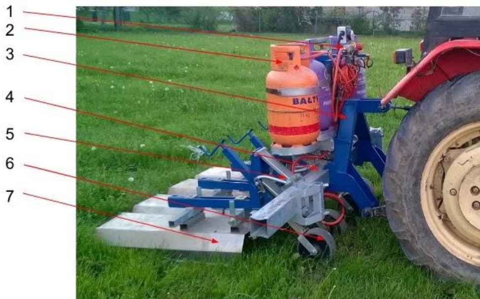
Rysunek 15. Widok ogólny Termopielnika T232 1 – zespół regulująco-redukcyjny gaz, 2 - butla propan-butan , 3 – wieszak trójpunktowego układu zawieszenia, 4 – główna belka nośna, 5–sekcja robocza, 6 – koło kopiujące sekcji, 7 – osłona palnika
