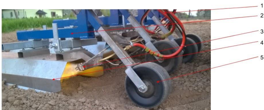
Rysunek 16. Widok sekcji roboczej Termopielnika T232 1 – przewód gazowy, 2 - rama nośna sekcji roboczej, 3 – palnik z zespołem zapalającym (iskrownikiem), 4 – osłona palnika , 5– koło kopiujące
