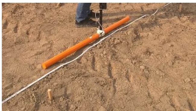
Rysunek 7. Konduktometr CMD-MiniExplorer
