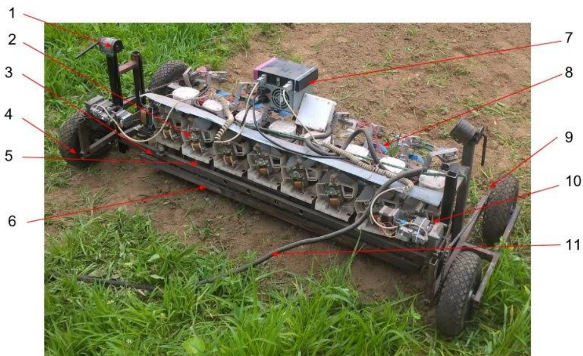
Rysunek 19. Pojazd do mikrofalowej dezynfekcji podłoża. 1 – mechanizm śrubowy regulacji wysokości anten, 2 - magnetron, 3 – rama, 4 – koło jezdne, 5– falowód z anteną, 6 – rama przesuwna, 7 – elementy elektryczne układu zasilania, 8 - wentylator chłodzący magnet
