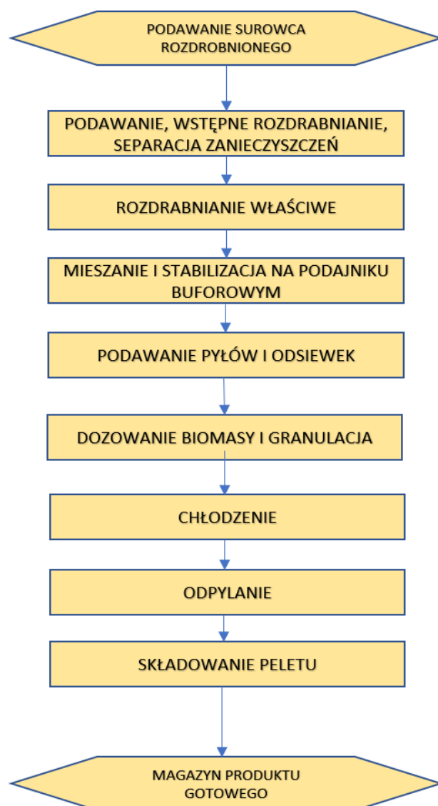
Rysunek 3.4. Schemat działania linii produkcyjnej na terenie badanej firmy
