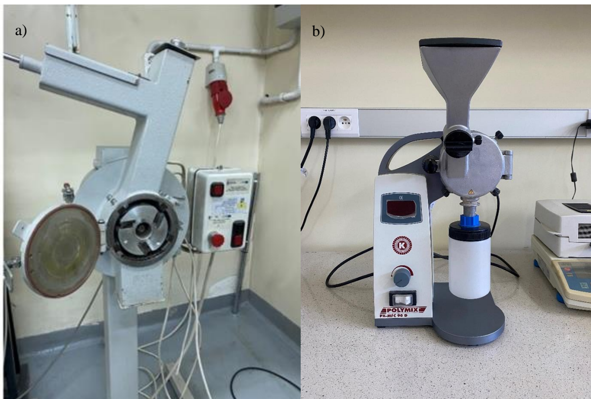
Rysunek 11. Młynki laboratoryjne: a - Testchem LMN-100, Polska, b - PX-MFC 90D, Polymix, Kinematika, Luzern, Switzerland
