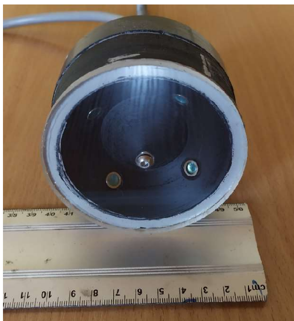
Rys. 6.10. Widok czujnika kierunku maksymalnego promieniowania słonecznego
